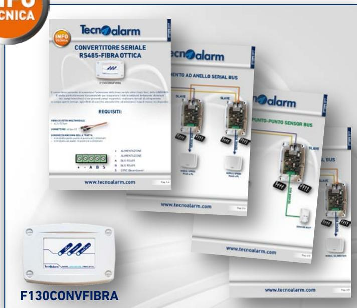
Il convertitore RS485-fibra ottica trasferisce i dati di una linea RS485 a lunga distanza tramite una dorsale in fibra ottica. Il documento mostra le modalità punto-punto e ad anello su serial bus e sensor bus.
